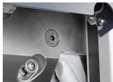
Jednoduché seřízení dořezu na přední části kulisy nože.
