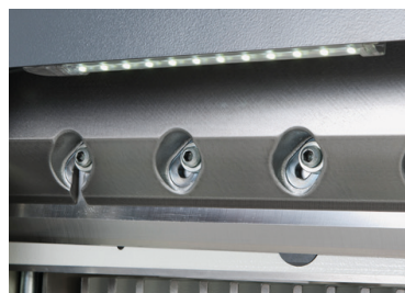
Osvětlení prostoru řezu LED diodami.
